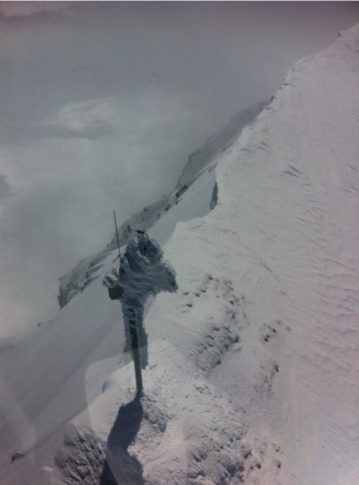
Verreifte IMIS-Windstation auf dem Ruchi (3107 m, Glarus Süd, GL). Die Station lieferte aufgrund von Verreifung vom 17. bis am 27.05. keine Daten (Foto: R. Stüssi, 27.05.2013).
