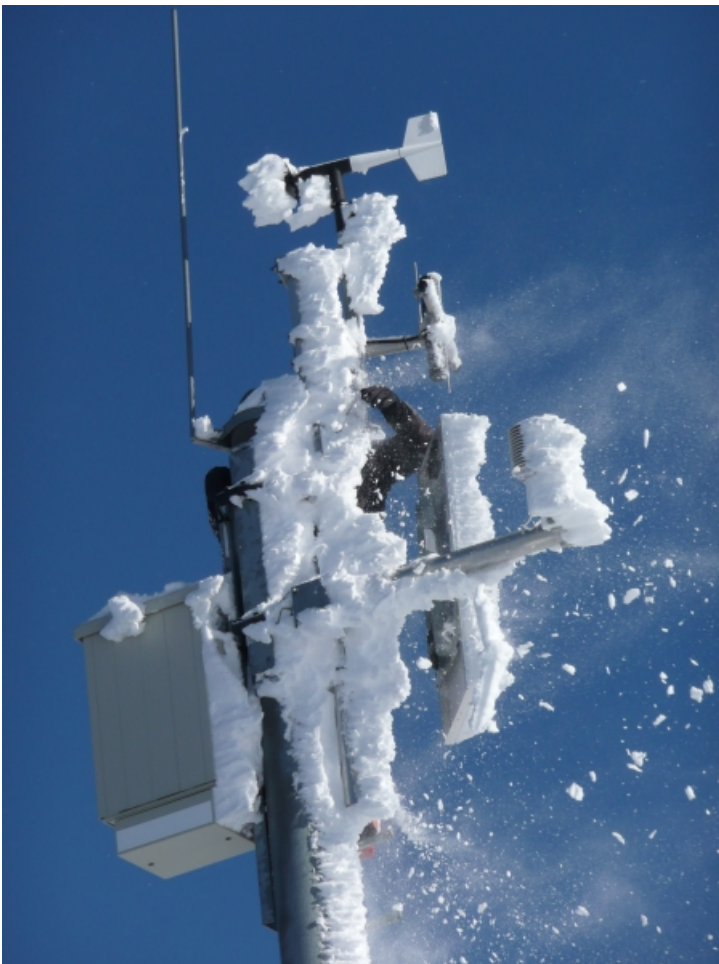
Die IFKIS-Stationen stehen auf vielen Berggipfeln und liefern den Lawinenkommissionen und der Lawinenwarnung unverzichtbare Daten zu jeder Tages- und Nachtzeit. Weil sie nicht ans Stromnetz angeschlossen sind, können die Sensoren nicht geheizt werden. Bei extremen Ereignissen können sie mit Raureif überzogen werden, wie hier am Pizzo Tremorgio im Tessin (Foto: E. Salinetti, 8.12.2008).
