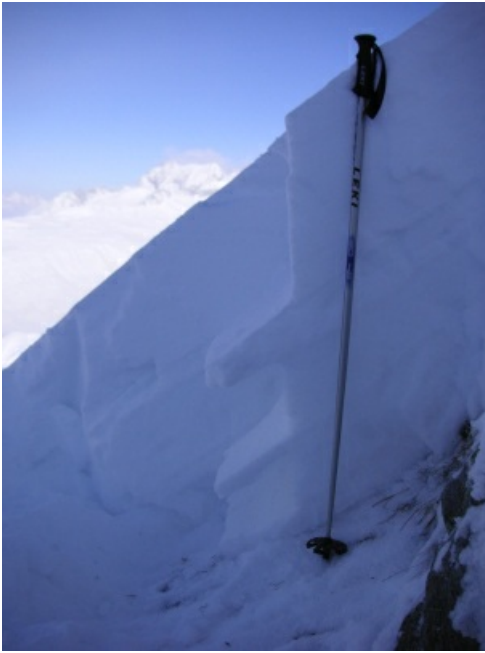
Schneeprofil am Gemsstock, Andermatt auf rund 2600 m. Die Folgen der Wärme- und Regenperioden dieses Winters sind deutlich als Krusten in der Schneedecke erkennbar (Foto: M. Hepting, 26.01.2007).
