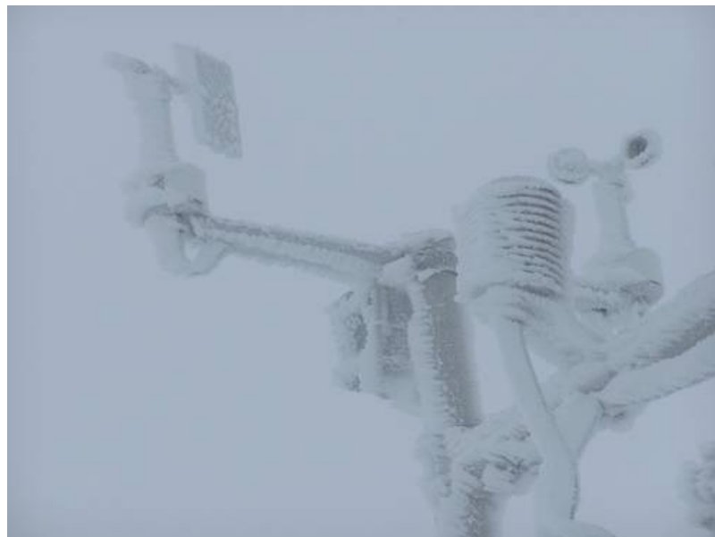
Photo 4: Formation de givre dur sur des objets exposés à une surfusion, comme par exemple à la surface du manteau neigeux ou comme ici, à une station de mesure automatique. (Photo: ENA/C. Pielmeier, 29.12.04)
