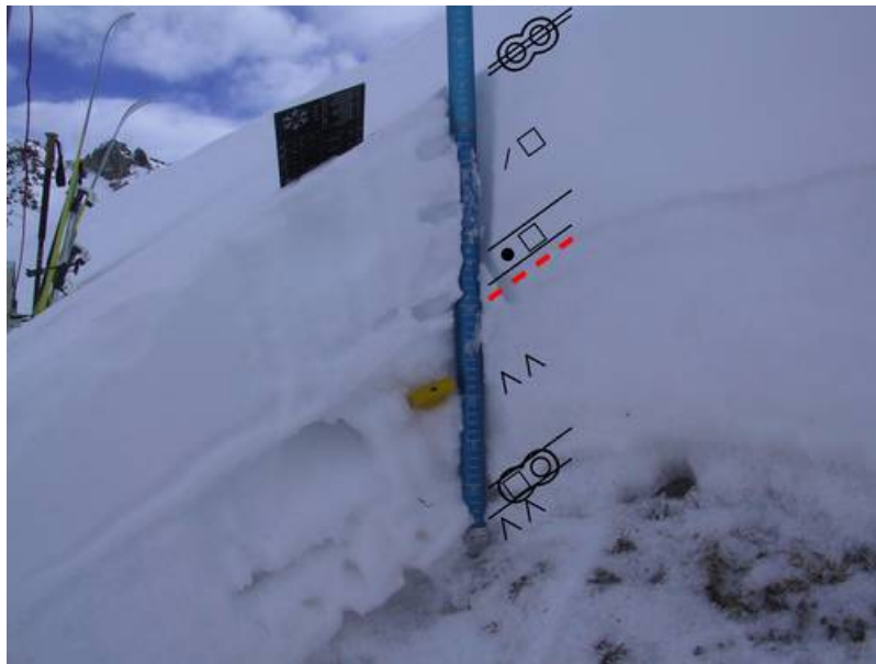
Photo 7: Profil d'enneigement sur une pente exposée au nord, altitude 2520 m, déclivité de la pente 36°, région de Parsenn, GR. Déclenchement au franchissement de la pente (ligne rouge), mais pas de glissement en raison de l'appui au pied de la pente. Les 30 cm d'épaisseur du fondement du manteau neigeux en dessous de la ligne rouge se composent largement de neige coulante (photo: ENA/Th. Stucki, 24.12.04).
