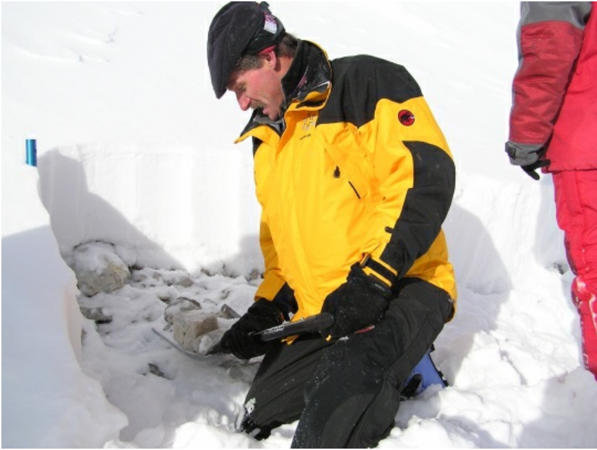
Wo die Lawinenwarner keinen Schnee fanden, mussten die Steine dran glauben. Beim Profilen am Weissfluhgipfel, Davos am 1.12.2004. Profil an SE-Hang, 30° auf 2750 m. Rutschblock brach bei Stufe 4 am Boden (Foto: SLF/C. Pielmeier, 1.12.2004).
