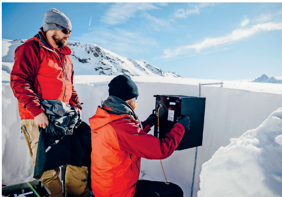
Mesure par infrarouge: le prototype du SnowImager en action.
