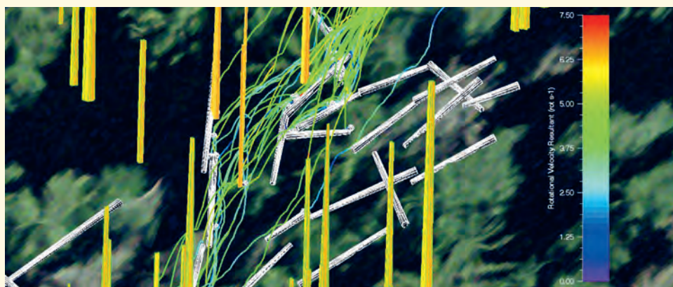
Les arbres sur pied (jaunes/orange) et à terre (blancs) influent sur la vitesse des pierres qui dévalent la pente (en vert dans la visualisation).
