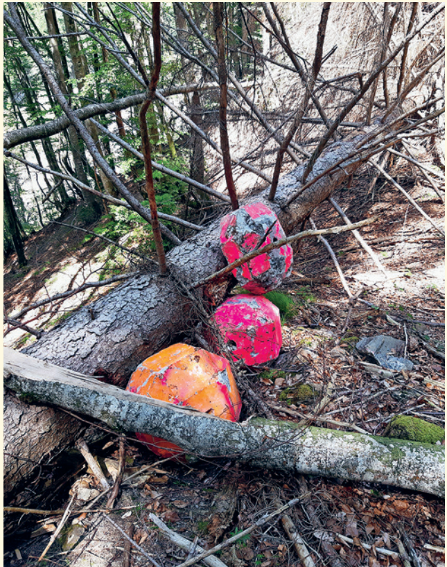
Richtig eingesetzt können auch abgestorbene Bäume gegen Steinschlag schützen, dies zeigen Computermodelle und Versuche wie hier in Schiers (GR). Aber die zusätzliche Waldpflege kostet – wäre die Bevölkerung bereit, etwas dafür zu zahlen?
