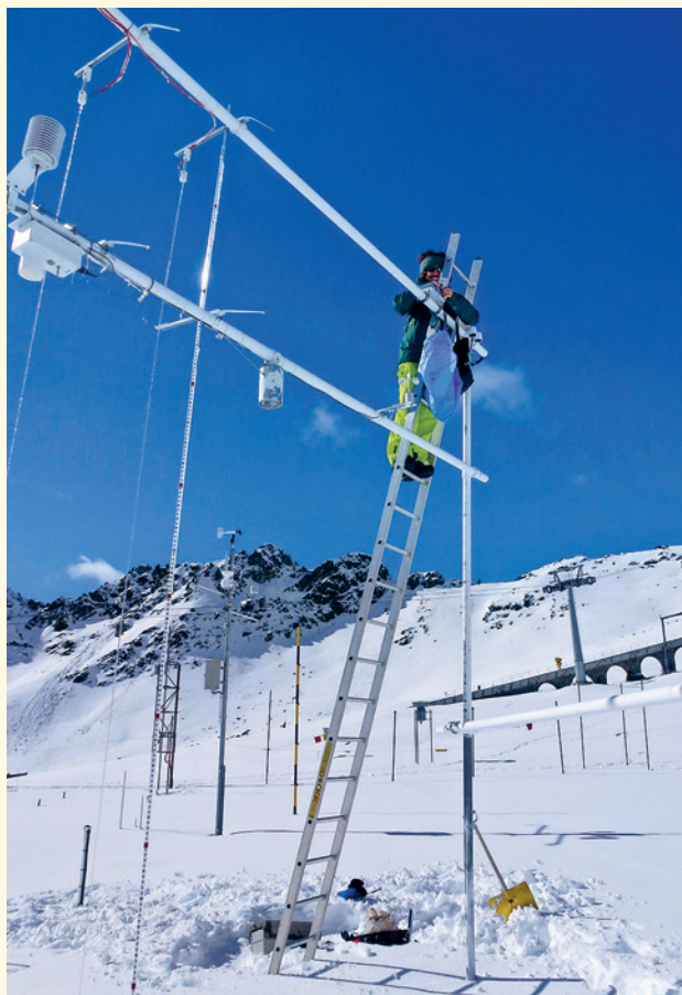
Ein Forscher überprüft den GPS-Sensor, der auf einem Mast im Versuchsfeld Weissfluhjoch bei Davos installiert ist.
