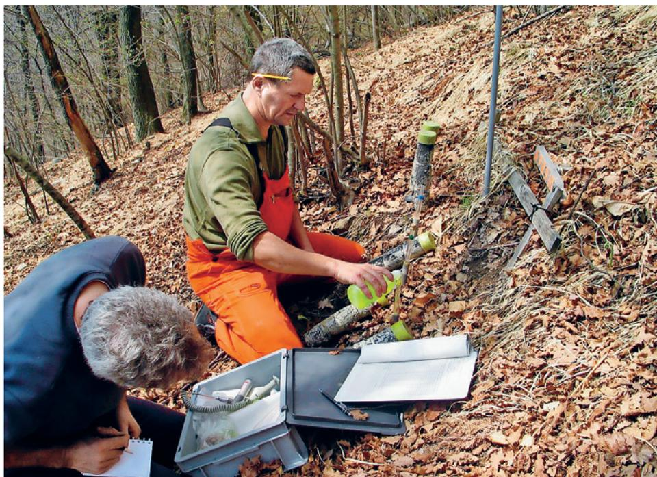
Dans le cadre du Programme de monitoring LWF, les chercheurs mesurent, à l'aide d'un tensiomètre, les forces que doit déployer une plante pour absorber l'eau du sol.
