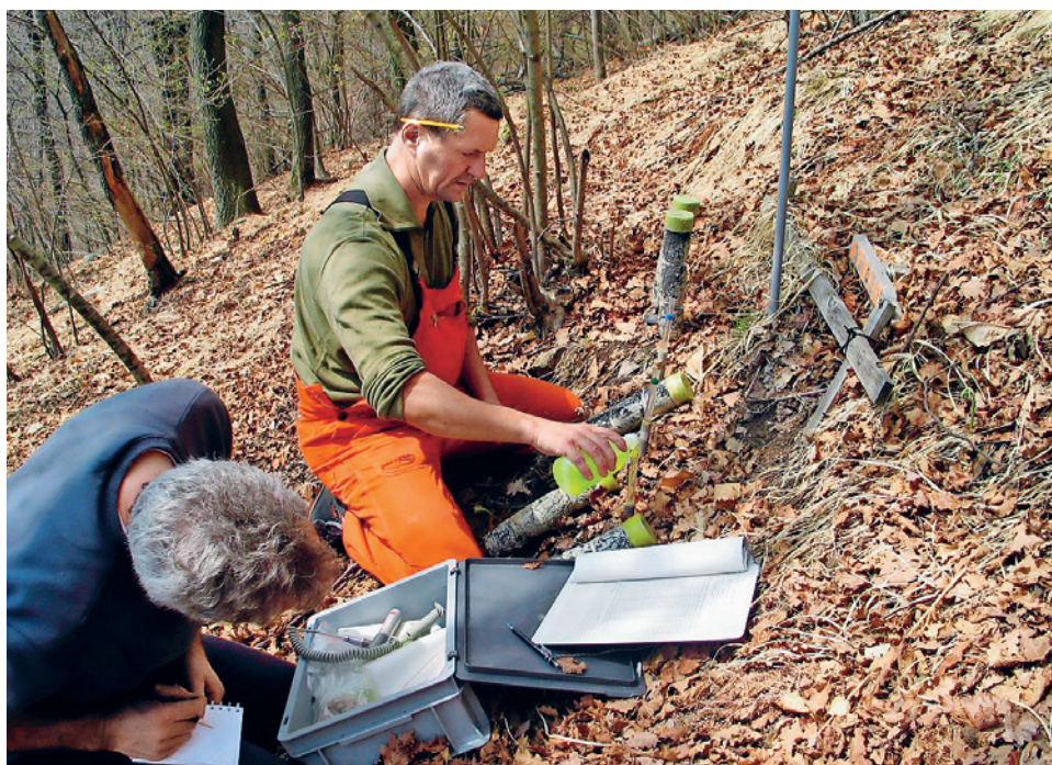
Im Rahmen des Monitoringprogramms LWF messen Forschende der WSL mit einem Tensiometer die Kräfte, die eine Pflanze überwinden muss, um Wasser aus dem Boden aufnehmen zu können.
