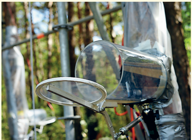
In dieser Kammer sammelt sich das CO 2 an, das der eingepackte Baum ausatmet.
