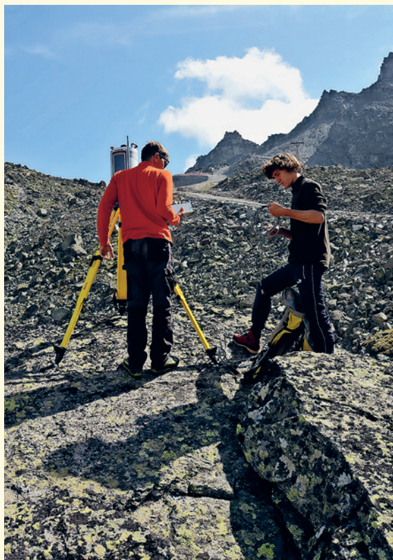
Laserscanning am Blockgletscher Ritigraben (VS).
