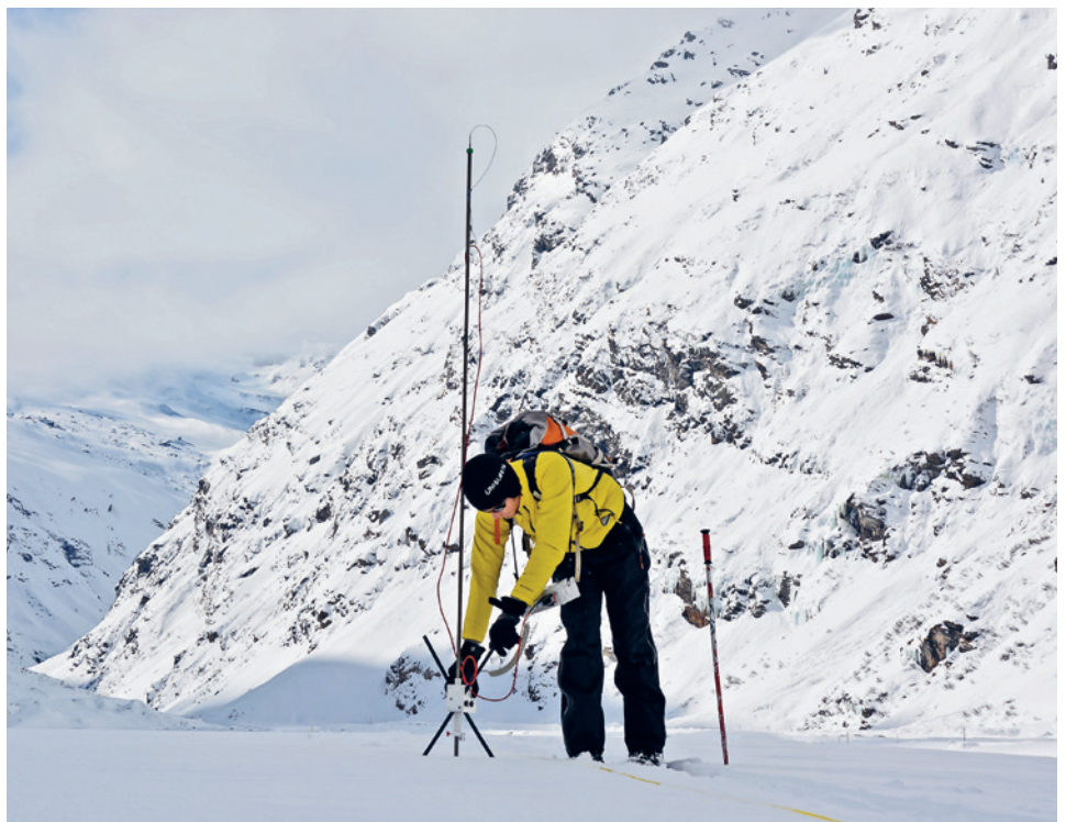
Mit dem SnowMicroPen vermessen die Forscher die Schichten im Inneren der Schneedecke rasch und genau.
