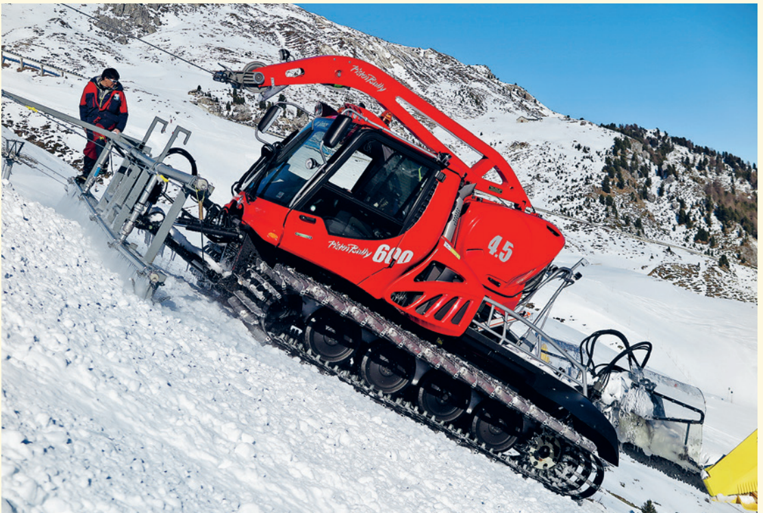
Eine Pistenmaschine wässert die Piste in St. Moritz mit dem Maschinenbalken, der sich vorne am Fahrzeug befindet.
