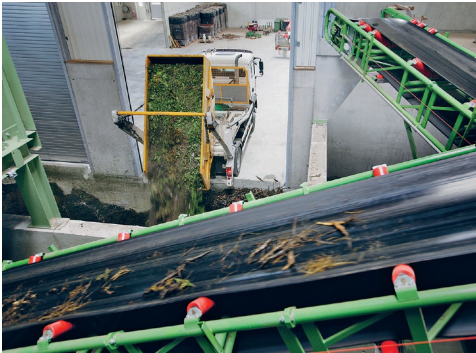
Der gesammelte Bioabfall wird auf eine Korngrösse von maximal 6 cm zerkleinert und dem Biogasfermenter zugeführt. Dort findet die industrielle Umwandlung von unverholzter Biomasse in Biogas statt.
