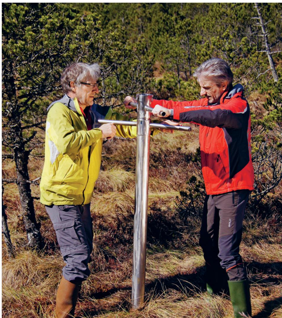
Alexandre Buttler (links) und Luca Bragazza (rechts) nehmen eine Bodenprobe, um zu erforschen, wie der Klimawandel Hochmoorböden von Kohlenstoffsinken in Kohlenstoffquellen verwandelt.
