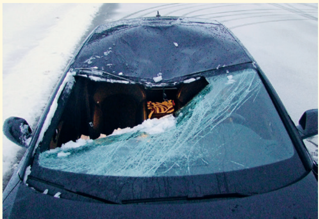
Im Februar 2014 hat ein Schneeblock, der vom Nordportal des San-Bernardino-Tunnels abbrach, dieses Fahrzeug schwer beschädigt.
