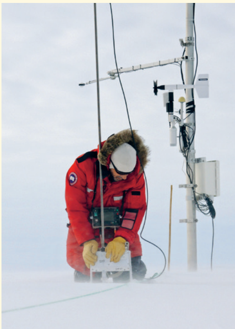
Martin Schneebeli untersucht mit dem SnowMicroPen die Schneedecke neben einer Wetterstation.
