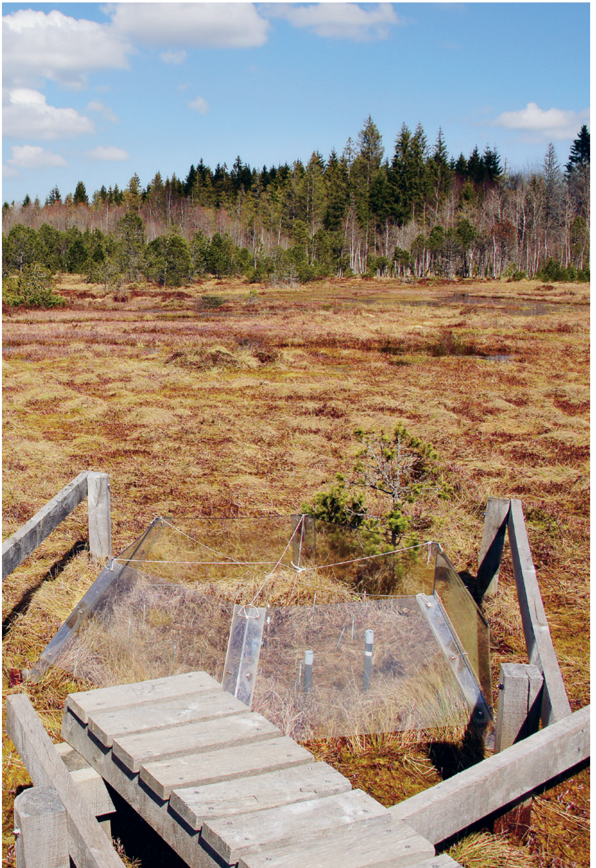
Im Hochmoor Le Forbonnet bei Frasné im französischen Jura simulieren Open-Top-Kammern kleinräumig den Klimawandel.
