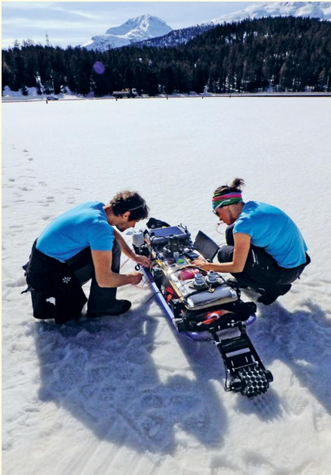
Forschende des SLF benutzen das neu entwickelte Radar, um den Wasserwert der Schneedecke zu messen.
