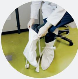
Schutzstufe 3: Eintritt durch Schleuse, Schutzkleidung.
