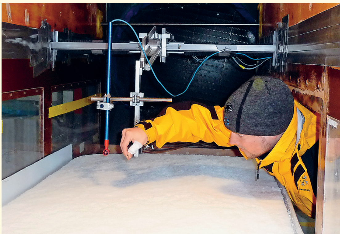
Dans la soufflerie du SLF, les chercheurs étudient le transport de la neige par le vent.
