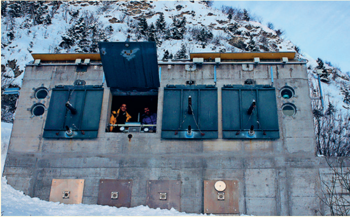
À l'aide d'un radar, les chercheurs étudient le comportement d'écoulement des avalanches depuis leur bunker d'observation.
