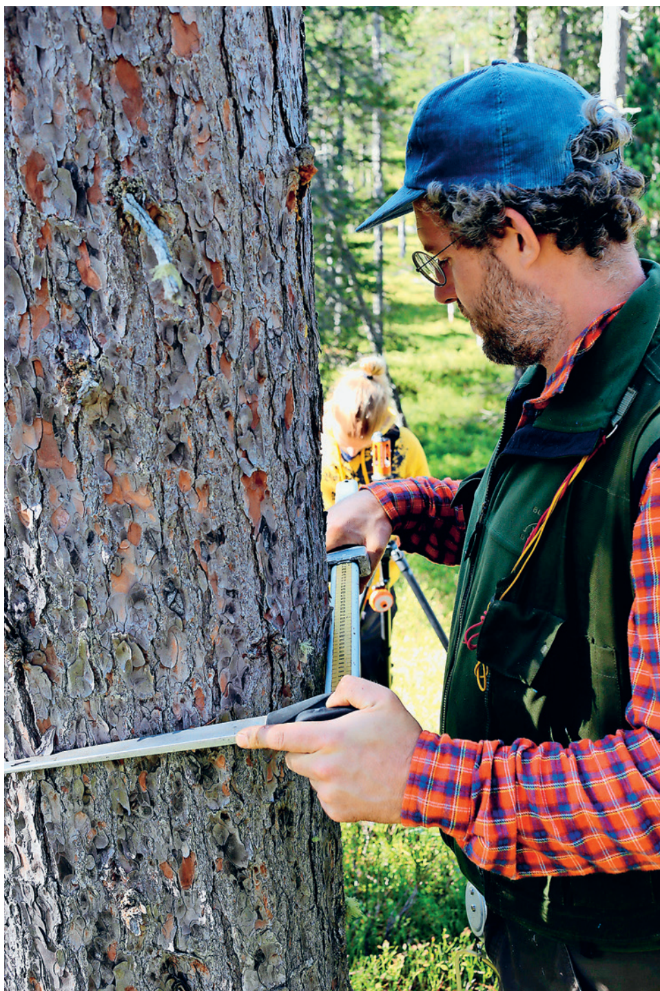
À l'aide d'une pince, Jonas Stillhard mesure le diamètre d'un pin de montagne.
