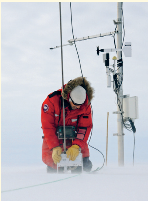
Avec le SnowMicroPen, Martin Schneebeli étudie le manteau neigeux à proximité d'une station météorologique.
