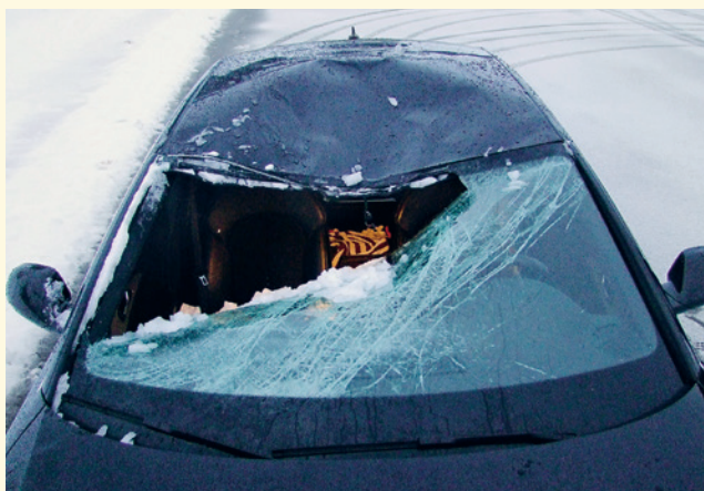
En février 2014, ce véhicule fut gravement endommagé par un bloc de neige qui s'était détaché de l'entrée nord du tunnel du San Bernardino.
