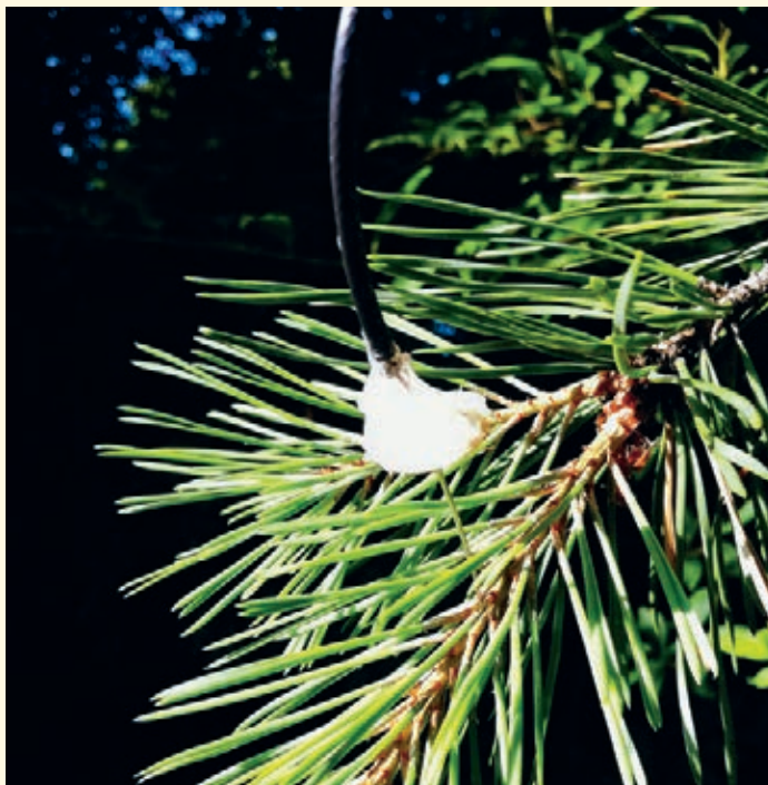
Un capteur piézoélectrique développé par les chercheurs eux-mêmes, et attaché aux aiguilles, mesure les signaux acoustiques sur un pin sylvestre.
