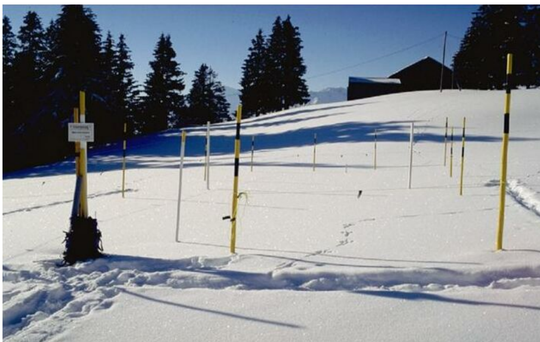
Fig. 1: Site de mesures d'environ 10x10 m avec délimitation, ligne de profils, perche à neige pour la mesure de hauteur de neige et table de neige fraîche.
