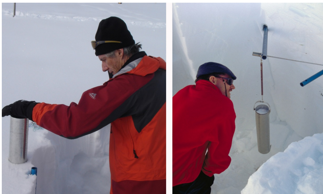
Fig. 3: Mesure de l'équivalent en eau: la balance à ressort doit être pendue si possible à un objet fixe (par exemple à la sonde de battage ou à un bâton de ski planté dans la neige). Veillez bien à ce que la sonde à teneur en eau soit suspendue librement.
