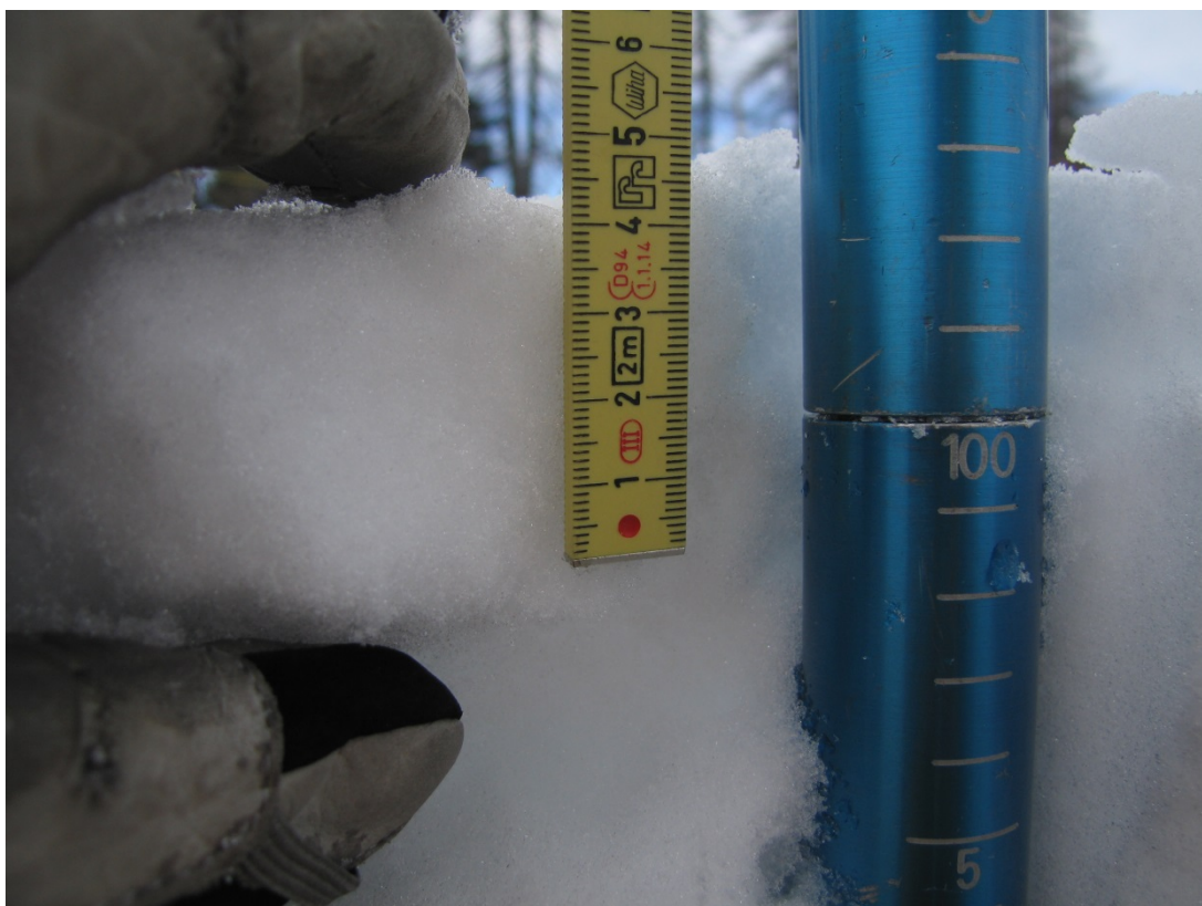
Fig. 4: L'épaisseur de la croûte est mesurée avec un double-mètre, lors de relevés de profils également sur l'échelle de la sonde de battage.
