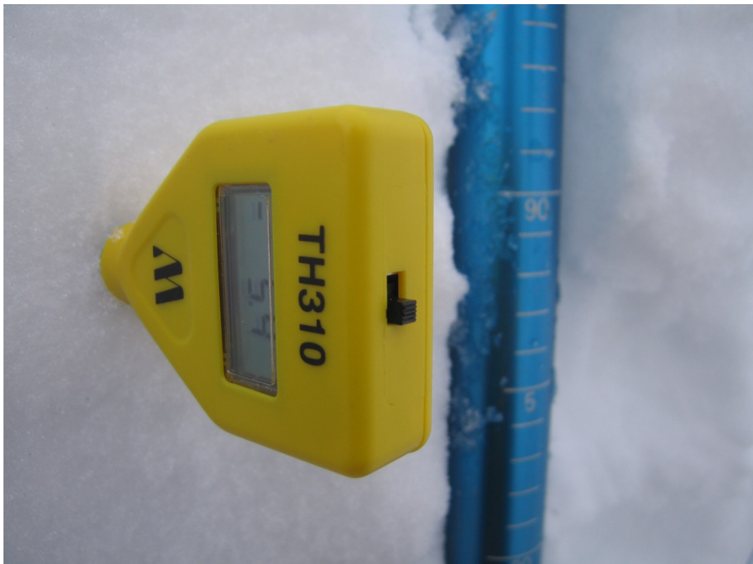
Fig. 7: Mesure de la température de la neige sur le profil de neige. La paroi du profil doit être protégée du soleil pendant les mesures.
