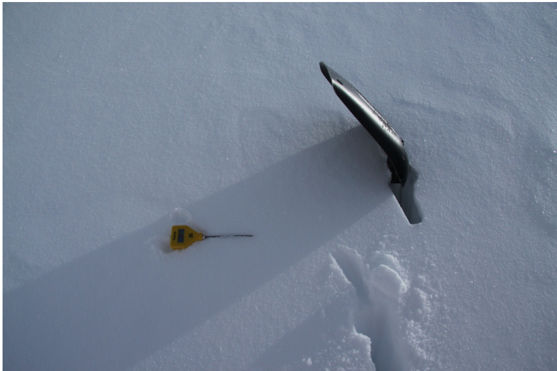
Fig. 6: Thermomètre mis à l'ombre pour la mesure de la température de surface de la neige. L'ombre ne doit être projetée que juste avant la mesure. La pelle ne doit pas se trouver au-dessus du thermomètre.
