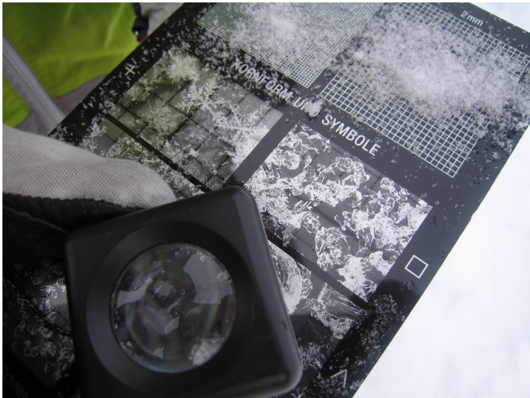
Fig. 13: Grille et loupe pour la détermination des formes et dimensions des grains.
