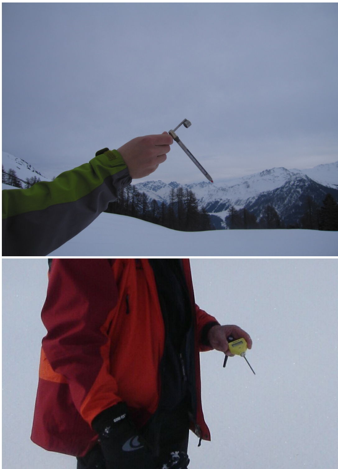
Fig. 5: Pour la mesure de la température de l'air, le thermomètre à alcool (en haut) est agité circulairement. Le thermomètre numérique (en bas) est moins adapté à la mesure de la température de l'air. Il est ventilé par un mouvement constant de va-et-vient. La mesure s'effectue toujours à l'ombre (éventuellement de votre corps).
