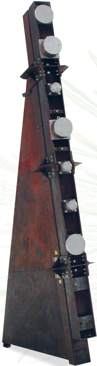
Stahlkeil mit Messinstrumenten für Lawinen
