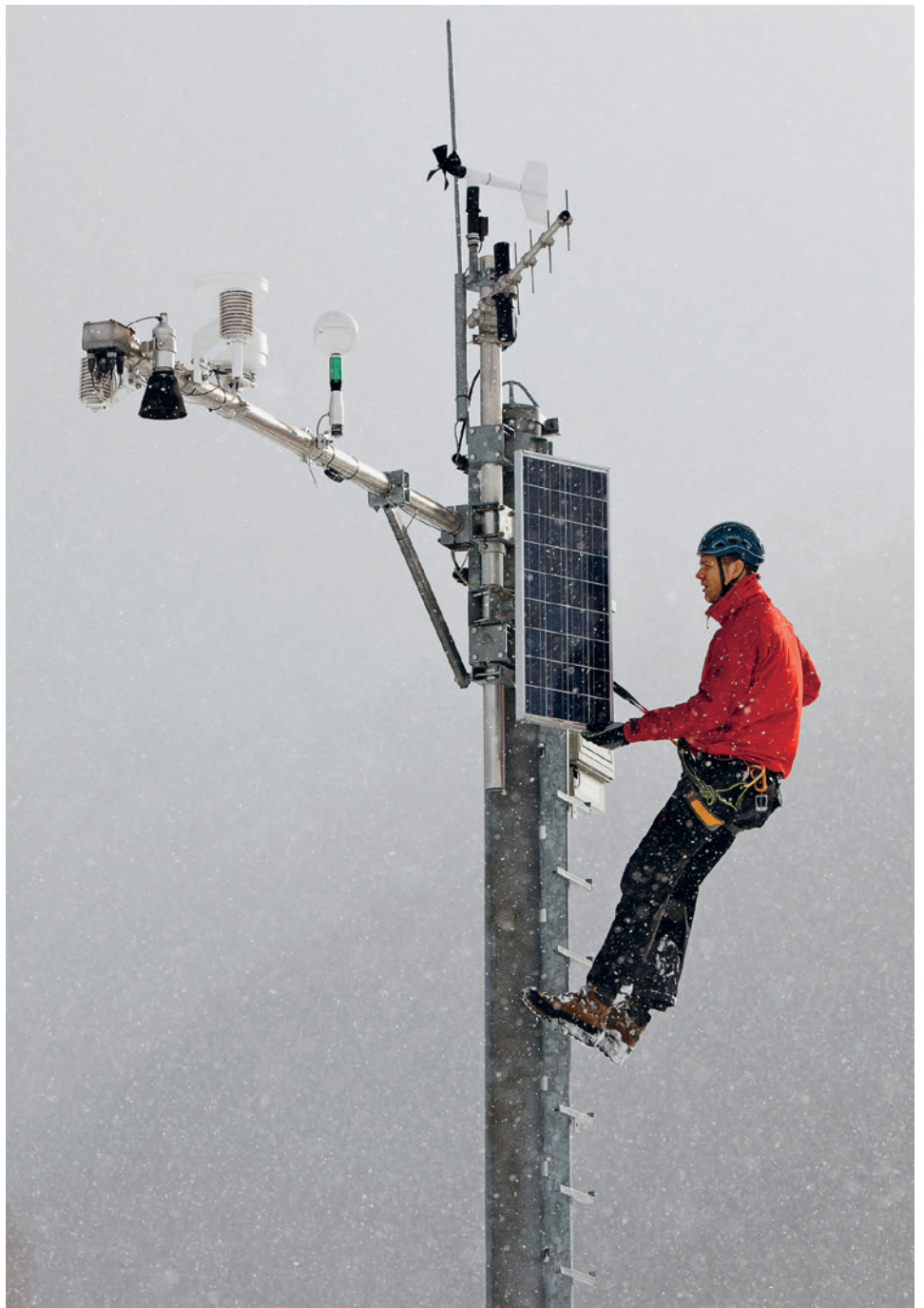
Messstation des Interkantonalen Mess- und Informationssystems IMIS. Sie liefert alle 30 Minuten aktuelle Daten zur Schneedecke.
