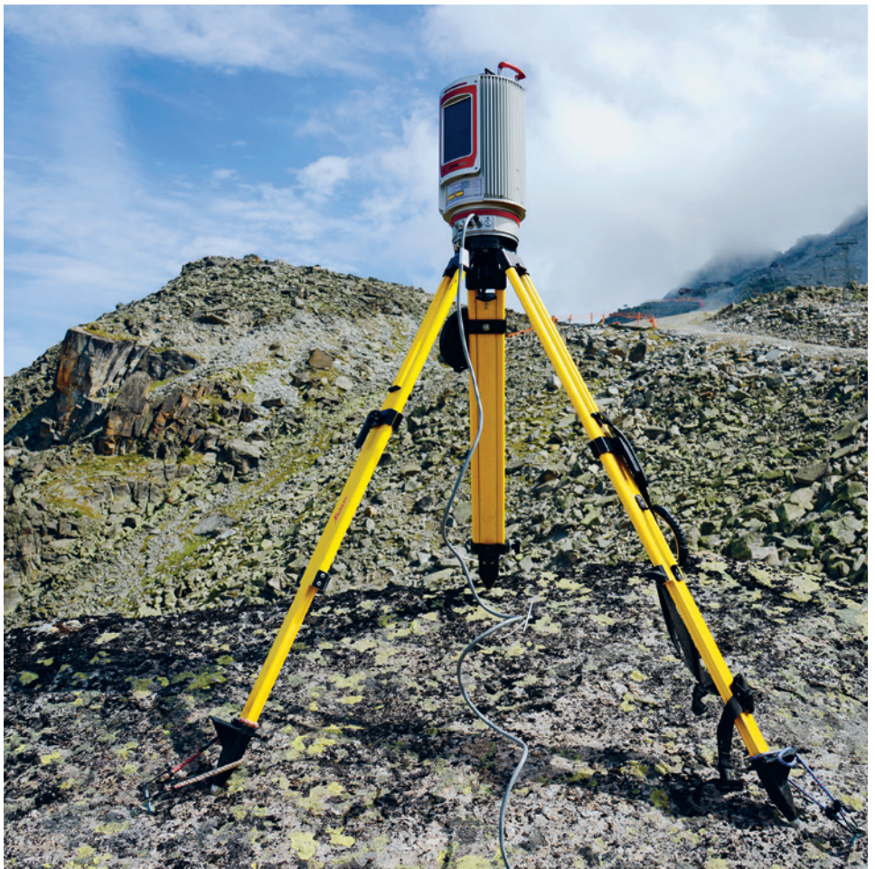
Dank periodischen Laserscanneraufnahmen des Geländes lassen sich auch kleine Bodenbewegungen feststellen.
