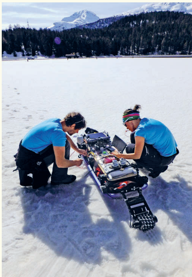
Des chercheurs du SLF utilisent le radar nouvellement développé afin de mesurer l'équivalent en eau du manteau neigeux.
