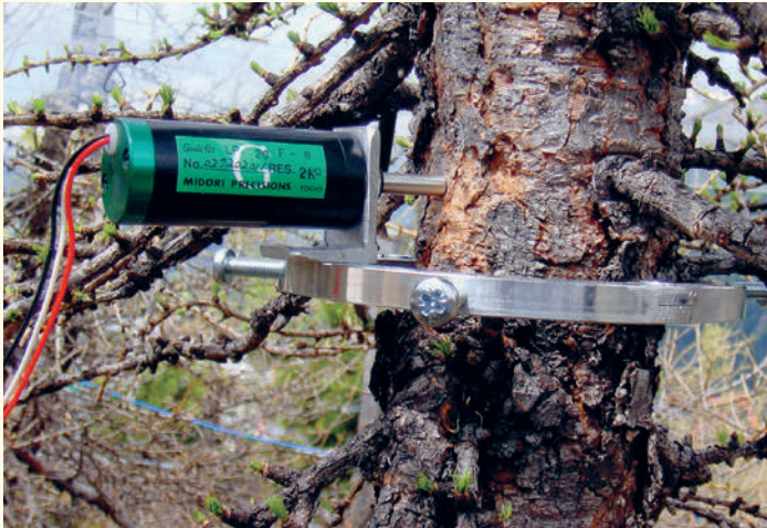
Un dendromètre enregistre l'ampleur des modifications du diamètre de l'arbre au fil de la journée.
