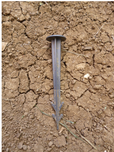
Abbildung 9. Erdnagel, ca. 15 cm lang. Quelle: Anita Nussbaumer.
