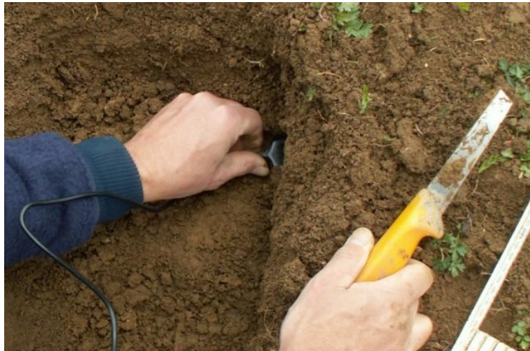
Abbildung 6: Platzierung eines MPS-2 Sensors in 15 cm Tiefe mithilfe eines stumpfen Messers.
