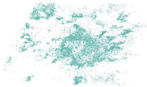
Abb. 3.6. Abbildung der geschnittenen Punktwolke auf der Höhe der im Feld durchgeführten Brusthöhendurchmesser(BHD)-Messung. Diese wurde verwendet, um Bäume zu identifizieren und deren BHD zu bestimmen basierend auf den terrestrischen Normalfarbenfotografien. Diese Abbildung zeigt die Problematik bei den Untersuchungsflächen gut1-3 im Untersuchungsgebiet Zugwald. Es konnten basierend auf den zugeschnittenen Punktwolken keine Bäume identifiziert und darum auch keine BHD bestimmt werden.
