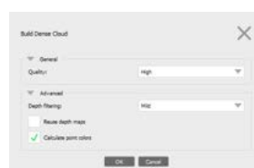
Abb. B.16. Je höher die Qualität, desto länger sind die Berechnungszeiten. Der Filter wird auf mild eingestellt, da sonst wichtige Details verloren gehen. Die Erstellung der verdichteten Punktwolke ist der zeitintensivste Schritt.
