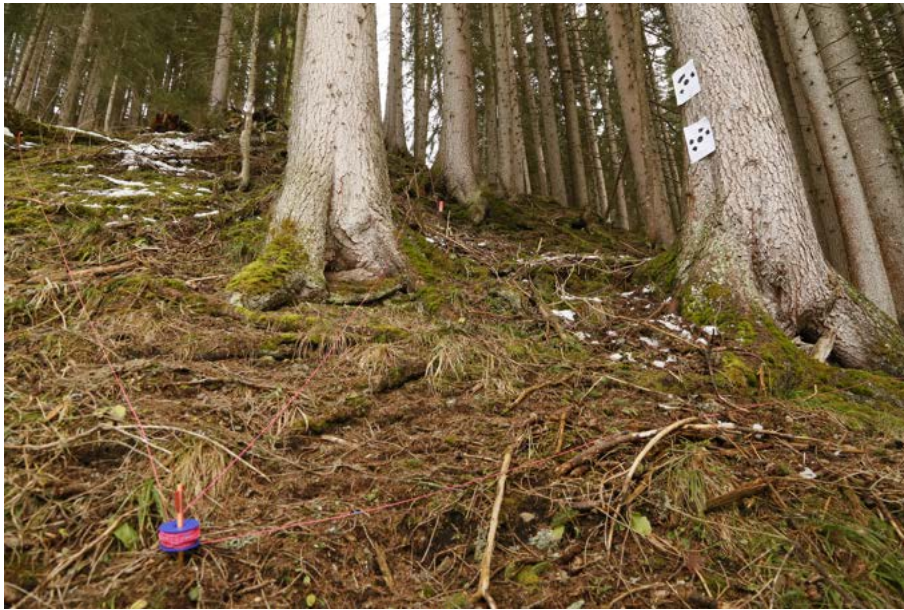
Abb. 2.5. Schema des Versuchsaufbaus für die terrestrischen Normalfarbenaufnahmen (RGB) in den Untersuchungsflächen. Die rosarote Eckfahne stellt einen Bodenkontrollpunkt (BKP) dar, welcher mit einem globalen Navigationssatellitensystem-Gerät (GNSS) eingemessen und zur Georeferenzierung der Aufnahmen verwendet wurde. Jede Untersuchungsfläche hat fünf BKP (4 Eckpunkte, 1 Mittelpunkt). Die Blätter an den Bäumen mit den unterschiedlichen Muster wurden als Kontrollpunkte verwendet. Die mit verschiedenen Mustern bedruckten Markierungen an den Bäumen sind die Kontrollpunkte (KP), welche zur späteren Validierung der Punktwolke vom Boden aus eingemessen wurden.
