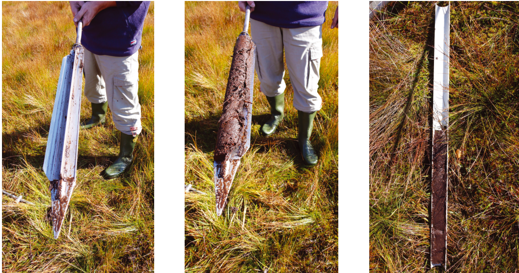
Abb. 14: Weissrussischer Torfbohrer / Torfprobe in Halbschale
