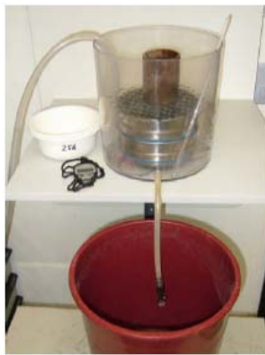
Abb. 32: Versuchsaufbau zur Bestimmung der Aggregatstabilität. Der Plastikbehälter wird für fünf Minuten mit Wasser geflutet und die zerfallenden Bodenpartikel werden auf den Sieben von 20, 10 und 0.2 mm Maschenweite aufgefangen.
