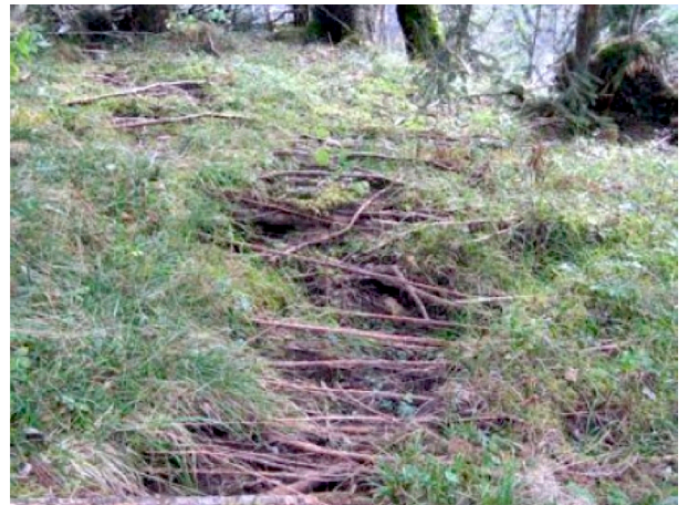
Abb. 6: Wurzelarmierung in Anriss (Quelle: Hunziker (ohne Datum); abgebildet in Schwarz und Thormann 2008, 27)
