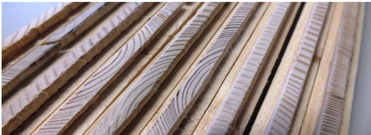
Abbildung 7. Bohrkern auf Holzträger und geschliffen. Rund 2000 Bohrkern von 5 verschiedenen Baumarten wurden vermessen und ausgewertet (Foto C. Zumbrunn).
