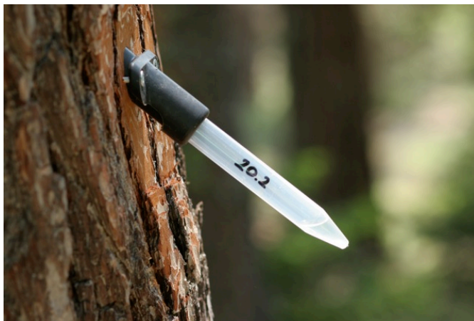
Abbildung 26. An der Rinde montiertes Röhrchen für die Harzflussmessung.
