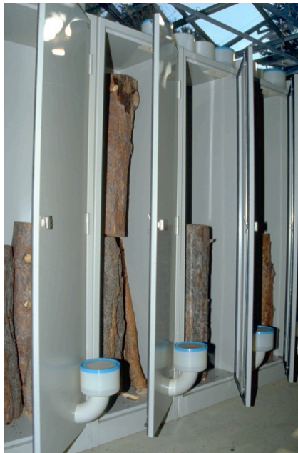
Abbildung 25. Eklektorkästen (= Schlupffallen) zum Ausbrüten von Insekten aus Föhren-Stammstücken.
