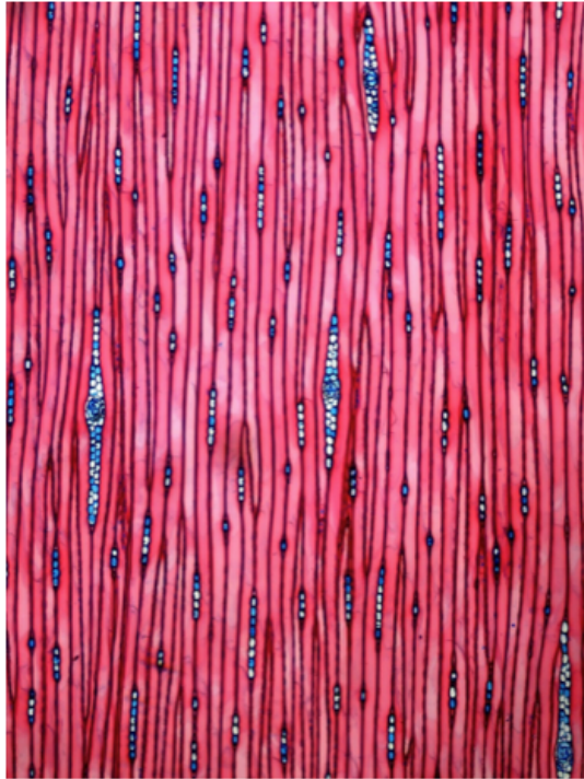
Abbildung 27. Tangentialschnitt durch das äussere Xylem einer Föhre. Die vertikalen, verholzten Fasern sind rot eingefärbt, die radial verlaufenden Harzkanäle blau.
