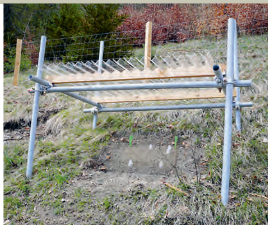
Abb. 1: Untersuchungsfläche in Bonaduz mit 15 Regendächern, die 0, \frac{1}{3} , oder \frac{2}{3} der natürlichen Niederschlagsmenge abführen. (Bilder: U. Wasem)
