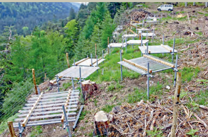
Abb. 1: Untersuchungsfläche in Bonaduz mit 15 Regendächern, die 0, \frac{1}{3} , oder \frac{2}{3} der natürlichen Niederschlagsmenge abführen. (Bilder: U. Wasem)
