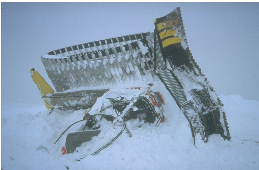
Abb. 3 Unfall bei der künstlichen Lawinenauslösung zur Pistensicherung. Der Pistenfahrzeugfahrer befand sich aufgrund mangelnder Warnung im Gefahrenbereich. Er wurde erfasst, im Fahrzeug verschüttet und verstarb (Foto: J. Schweizer, SLF)
