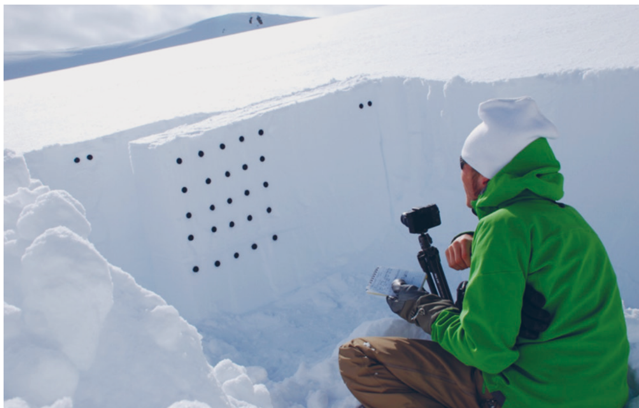
Abb. 2: Mit dem PST, einem bruchmechanischen Test zur Bestimmung der kritischen Risslänge, lässt sich die Neigung der Schneedecke zur Bruchausbreitung bestimmen. Letztere hängt von der komplexen Wechselwirkung zwischen den Eigenschaften der Schwachschicht und der überlagernden Schichten, dem Schneebrett, ab.
