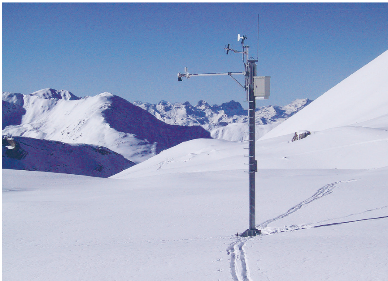
Abb. 2: Die «Schneestation» der IMIS-Station Bärentäli in der Landschaft Davos, GR. Der Standort für die Messung von Schneeparametern liegt in der Regel entfernt von Kämmen und Gipfeln, im Bereich einer flachen Stelle mit möglichst gleichmässiger Schneeverteilung (Foto: SLF/Th. Stucki).
