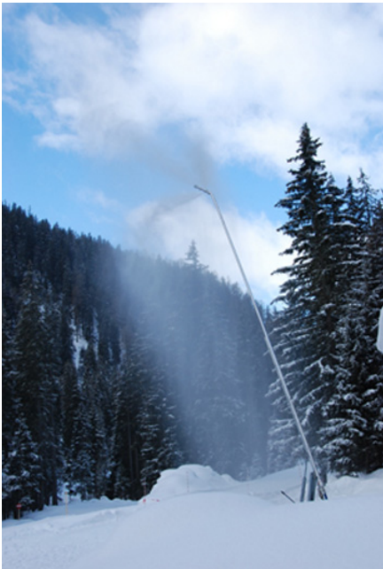
Abb. 1: Die neuen NESSy-Schneilanzen verbrauchen 80 % weniger Energie und können bei bis zu 2 °C höheren Temperaturen als herkömmliche Schneilanzen Schnee produzieren (Foto: M. Fauve, SLF).
