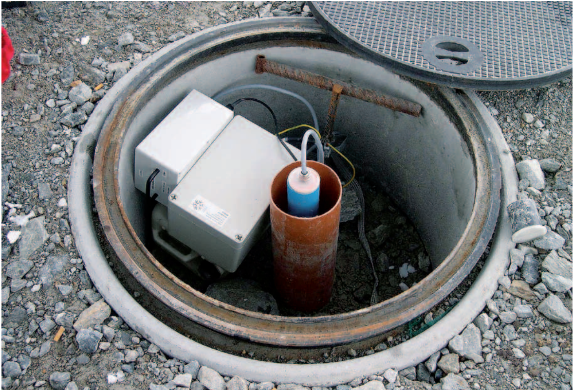
Fig. 35: Pozzo con coperchio per proteggere il foro di sondaggio, il tubo e gli strumenti di misura.
