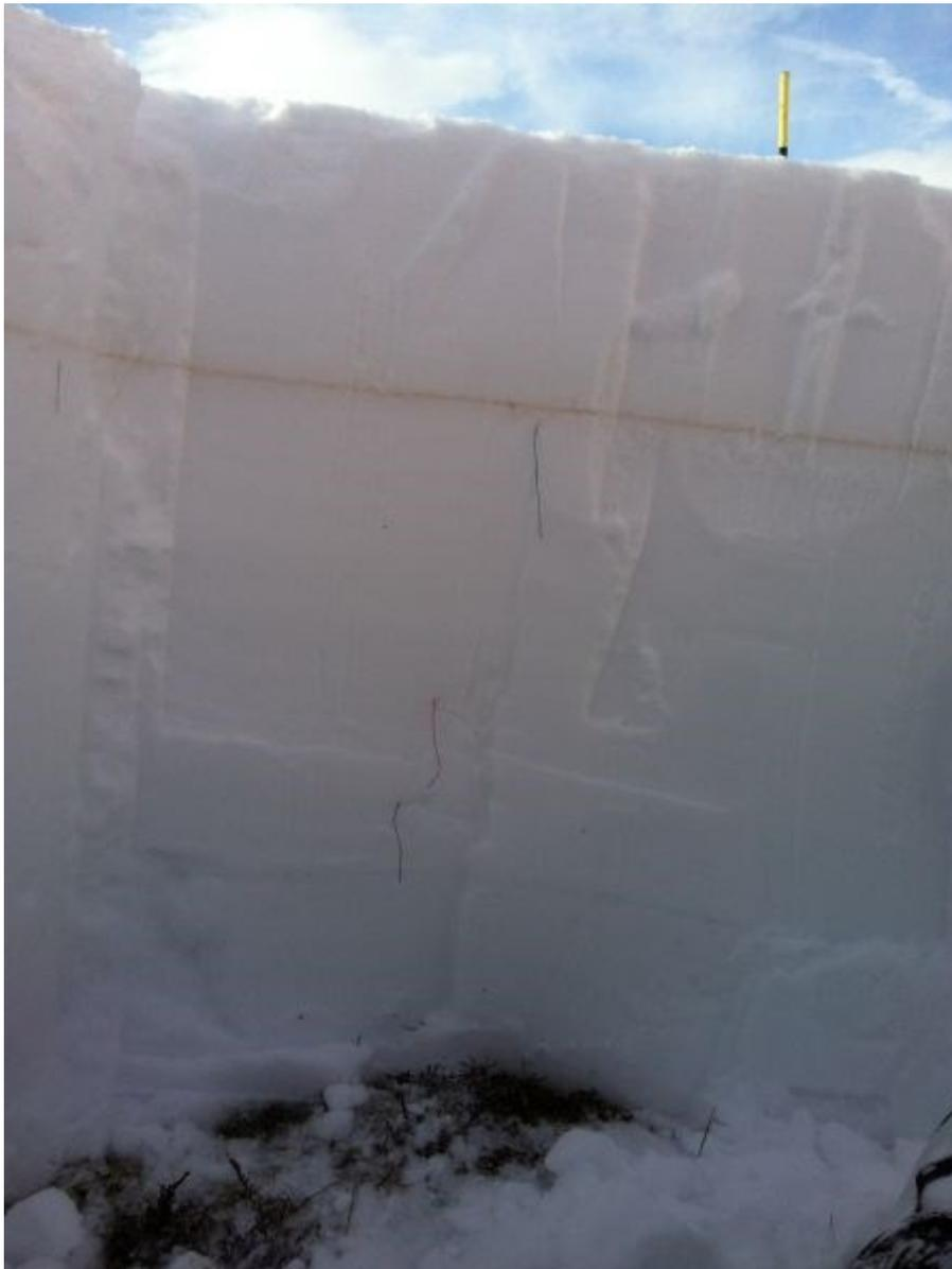
Abb. 2: Bei Flachfeldprofilen dokumentieren Fäden die Schneeoberflächen bei jeder Profilaufnahme. Saharastaub lässt ebenfalls eine genaue Datierung von Schichten zu (Foto: Firstbahnen, 28.02.2014).
