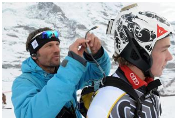
Abb. 2: Ausrüstung des Testfahrers mit GPS und Inertialsensor am Lauberhornrennen (Foto: A. Blatter).
